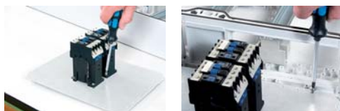
Styczniki na płycie montażowej
