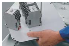
Styczniki na płycie montażowej
