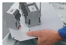
Styczniki na płycie montażowej
