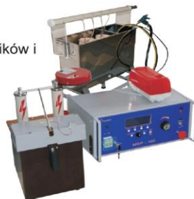
Blok sterowania MSP-100 Blok transformatorowy BWI-30 Wanna do badania obuwia i rękawic
