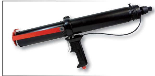
Produkt Art.-Nr. Szt. Pistolet dozujący pneumatyczny, stalowy, do kartuszy 10:1, 380 ml DPP380S 1
