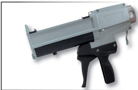
Produkt Art.-Nr. Szt. Pistolet dozujący manualny, plastikowy, do kartuszy 1:1, 400 ml DPM400P 1
