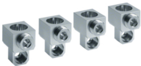
Zaciski klatkowe Al/Cu x250/h250 Al 4P 1x 95-240mm
