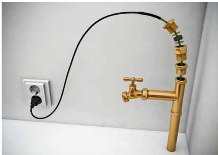
Kabel grzejny jest wprowadzany do rury z wodą za pośrednictwem odpornego na ciśnienie elementu uszczelniającego (EFPV1). (ILUSTRACJA MA CHARAKTER WYŁĄCZNIE POGŁĄDOWY)
