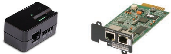
Opcjonalna karta Web/SNMP z detektorem EMP do pomiaru temperatury w zewnętrznych szafach bateryjnych lub na stojakach bateryjnych.
