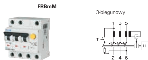
typ A, I_n do 40 A, I_{cn} = 10 kA (stosowany w Norwegii)
