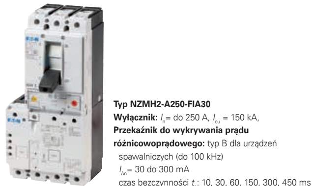
Fig. 41 Wyłączniki z zabezpieczeniem różnicowo-prądowym do zastosowań przemysłowych (CBR)
