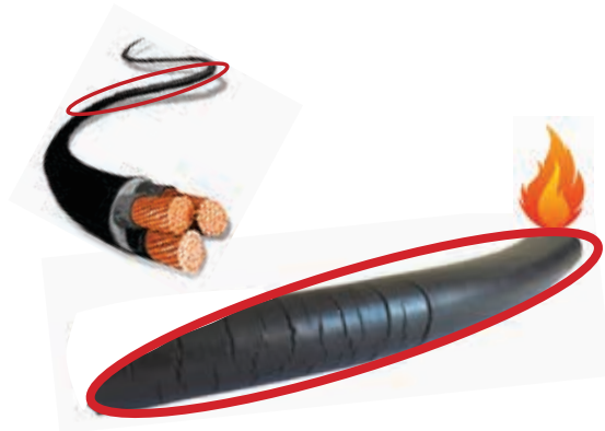
Rys. 62 Występowanie pożaru wskutek prądów pelzających
