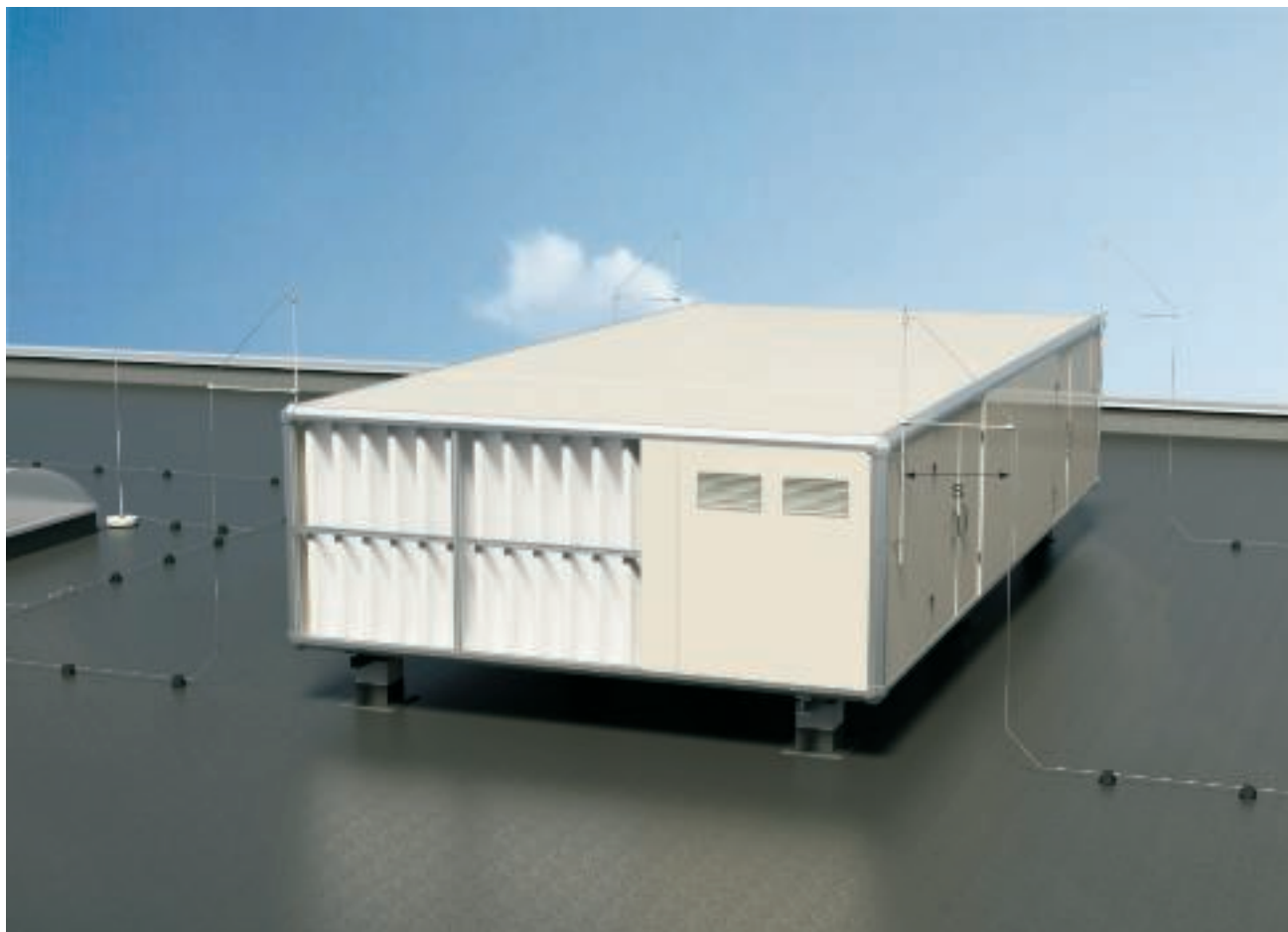
Izolowana ochrona odgromowa z zachowaniem odstępu izolacyjnego (s)
