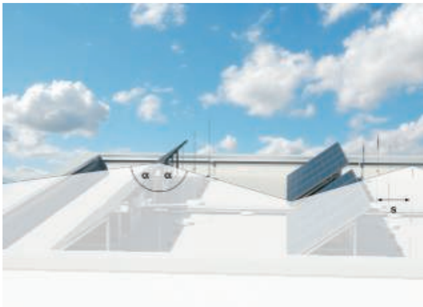
\alpha^\circ = Kąt ochronny, s = Odstęp separacyjny
